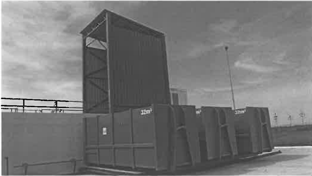
4. ábra: A átrakóállomás beömlő kosara és a gördülő abroll konténerek
